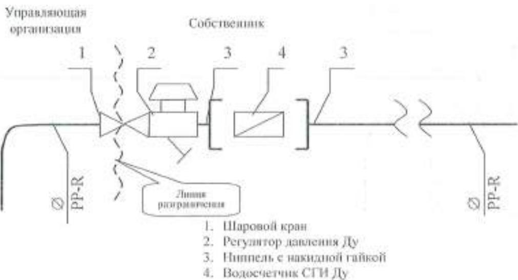
Исполнитель несет ответственность за надлежащее состояние и работоспособность систем горячего и холодного водоснабжения согласно вышеуказанной схеме до волнистой линии слева (включая шаровой кран).
